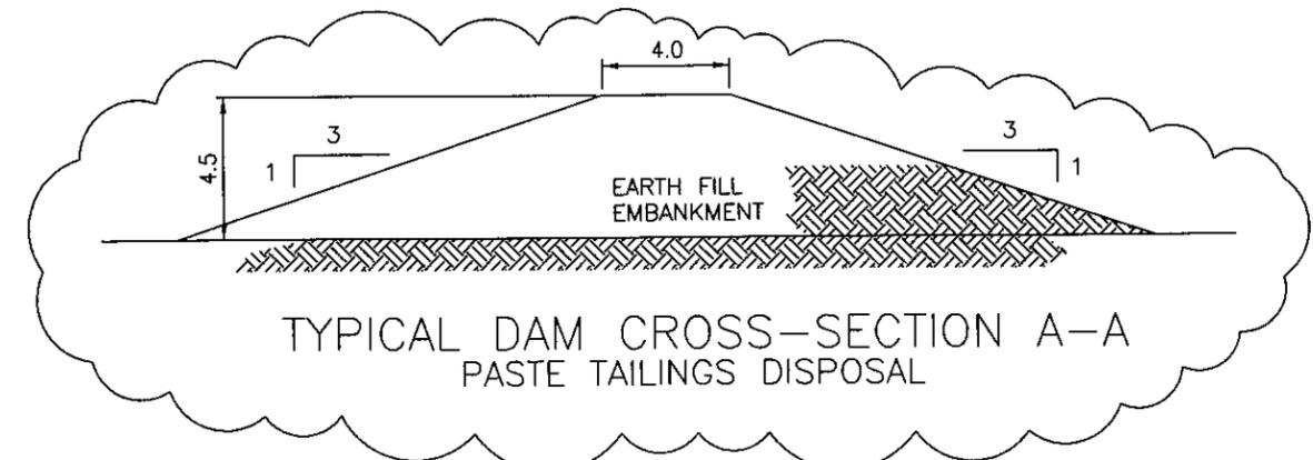
TYPICAL DAM CROSS-SECTION A-A
