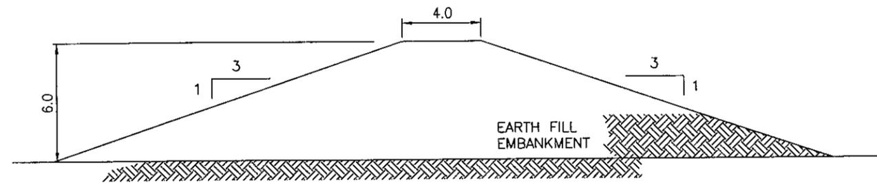
TYPICAL DAM CROSS-SECTION A-A
